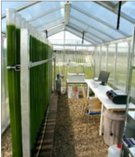
Das Rauchgas wird über ein spezielles Pumpsystem ventilgesteuert in den Bioreaktor gespritzt. Dort wandeln die Mikroalgen \text{CO}_2 in Biomasse um.
